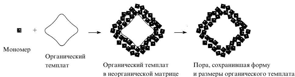
Рис. 6. Схема темплатного синтеза.
